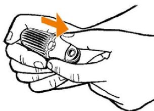
4. Снимите крышку охлаждающего блока с основания.
